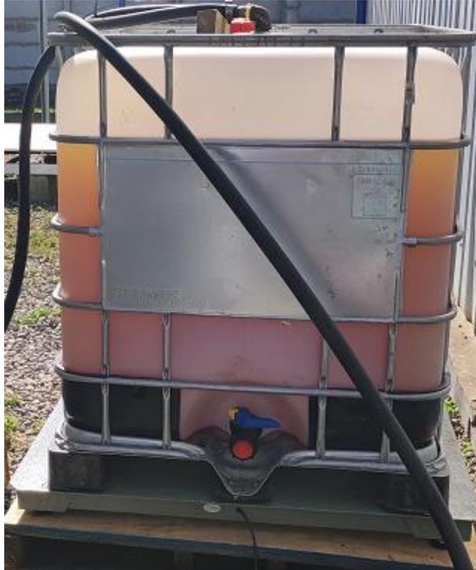
Figura 9.36 – Estanque de combustible auxiliar y balanza de plataforma
