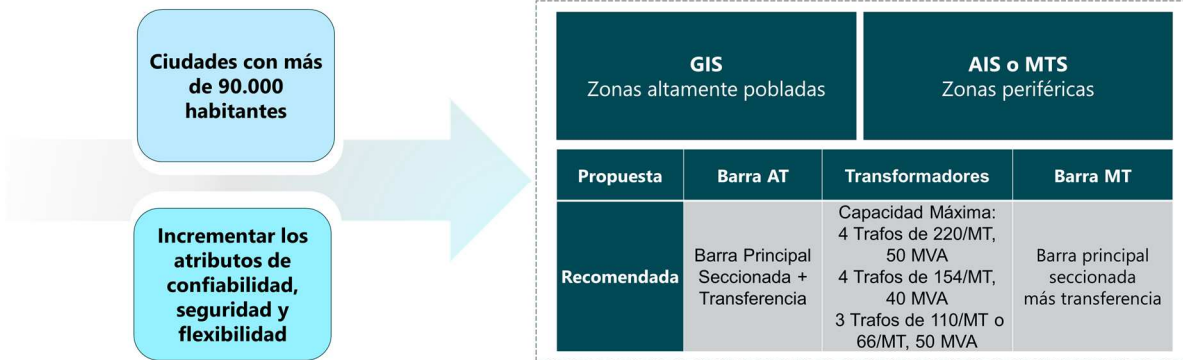
Ilustración 8-7. Propuesta de configuraciones de barra para ciudades regionales con más de 90.000 habitantes.
