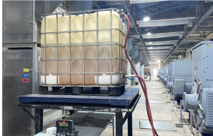
Figura 3: Sistema de estanque y balanza utilizado para medir consumo de combustible
