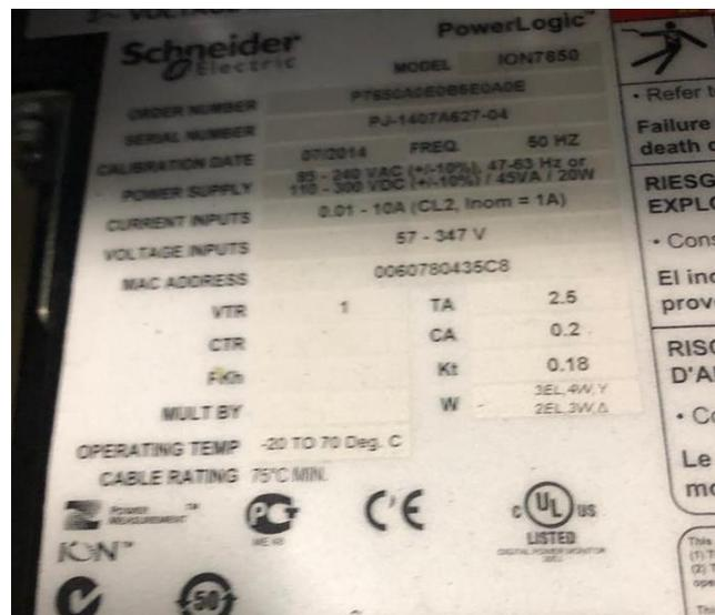
Figura 9.3 – Datos de placa medidor de potencia bruta y factor de potencia - Unidad 1
