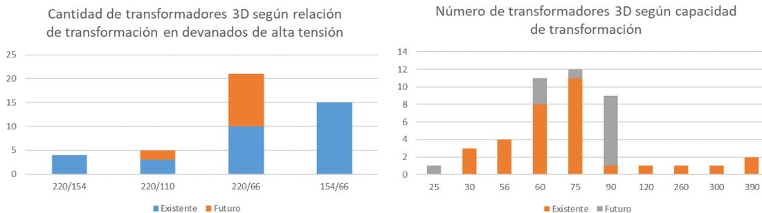
**Figura 5-122. Cantidad de transformadores de tres devanados por razón de transformación y según su capacidad de transformación, zona Charrúa – Chiloé.**
