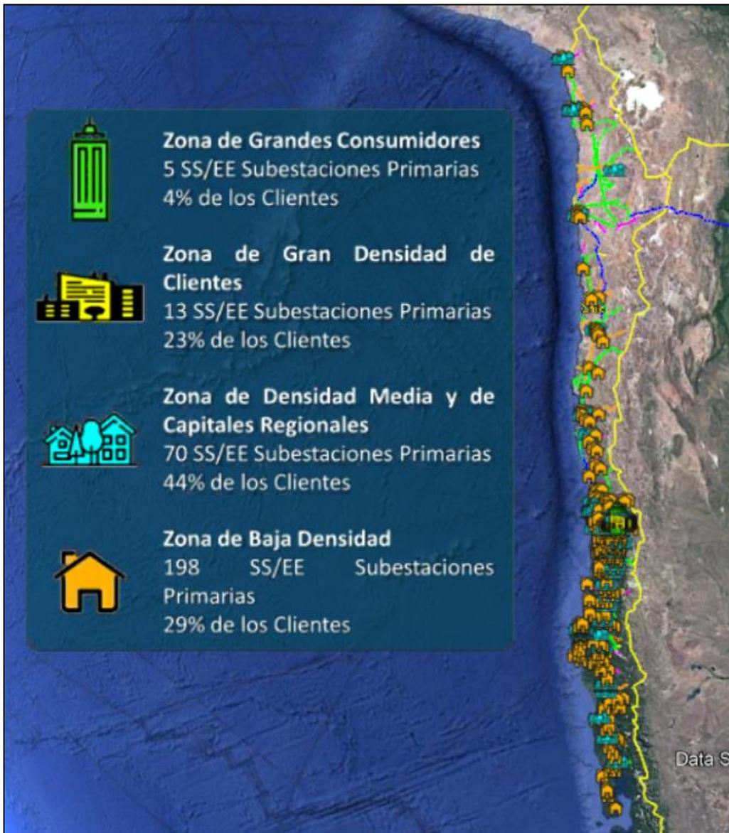
Figura 4-20 Esquema georreferencial de clasificación de subestaciones primarias.
