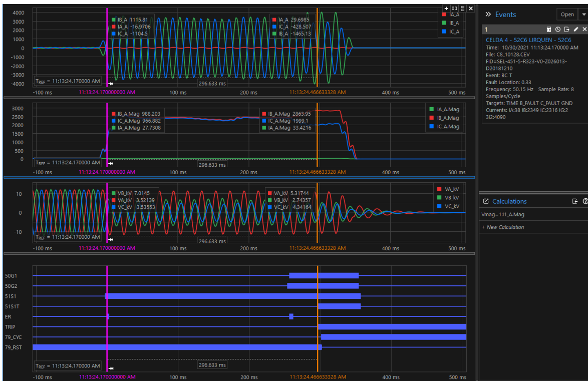
Registro oscilográfico Relé SEL 451 de paño C6 de SE Mahns.
