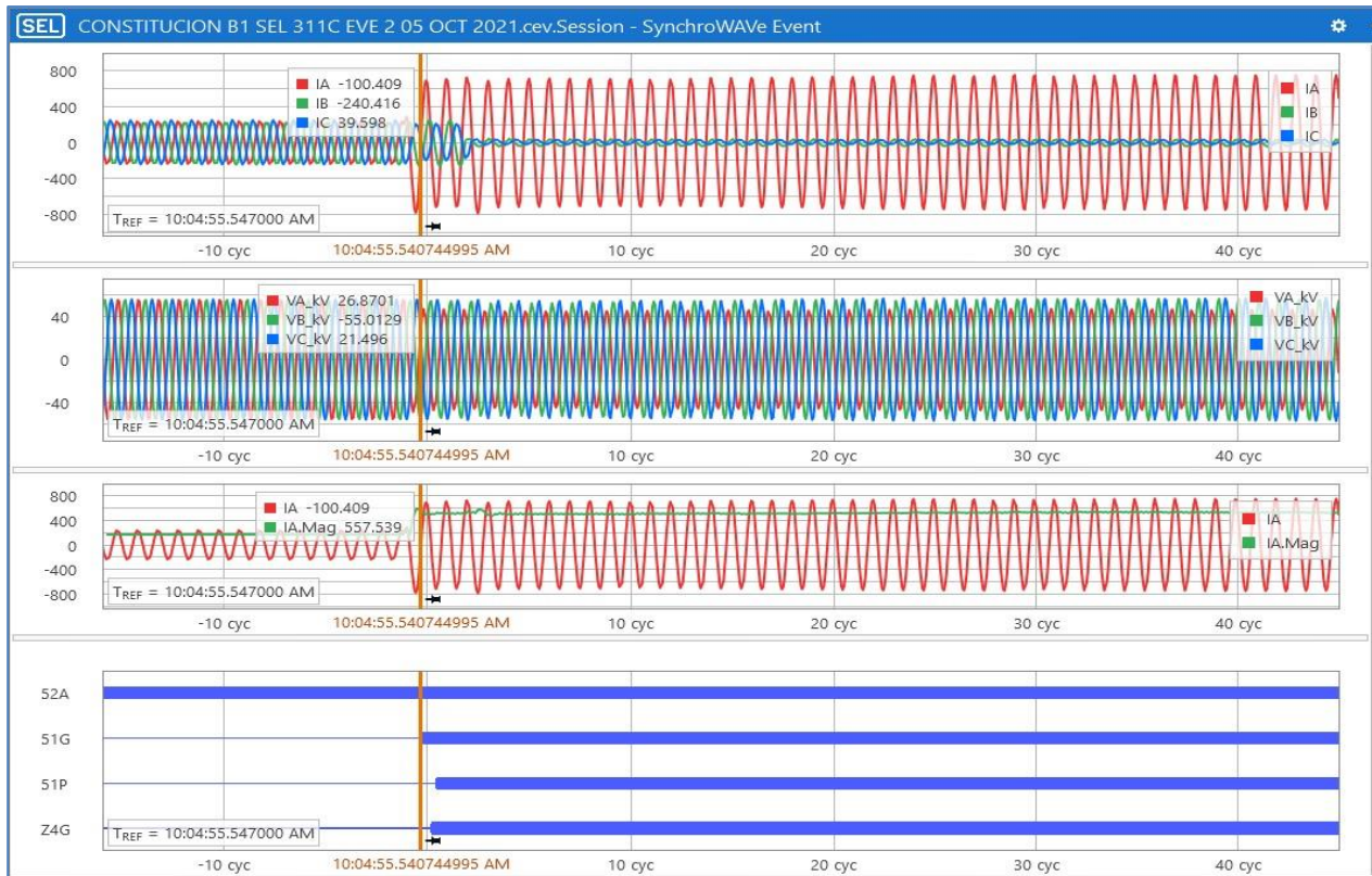
Figura N°4. Oscilografía del primer evento 52B1 SE Constitución
