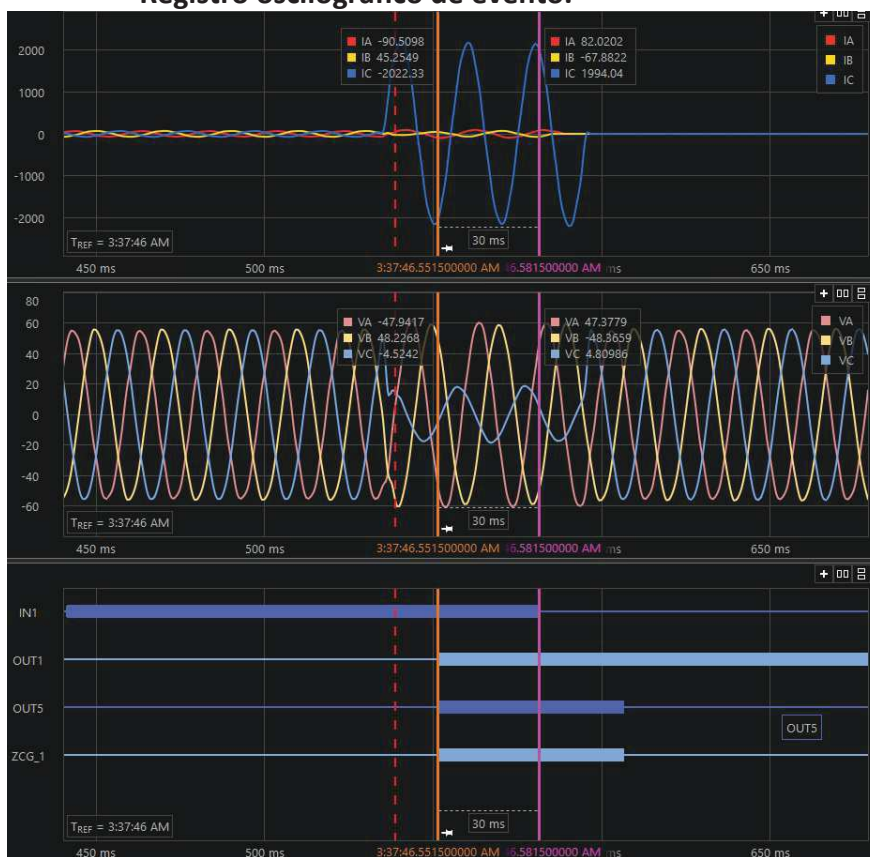
Registro oscilografico Relé SEL 321 del Paño 52B4 SE San Vicente TT.
