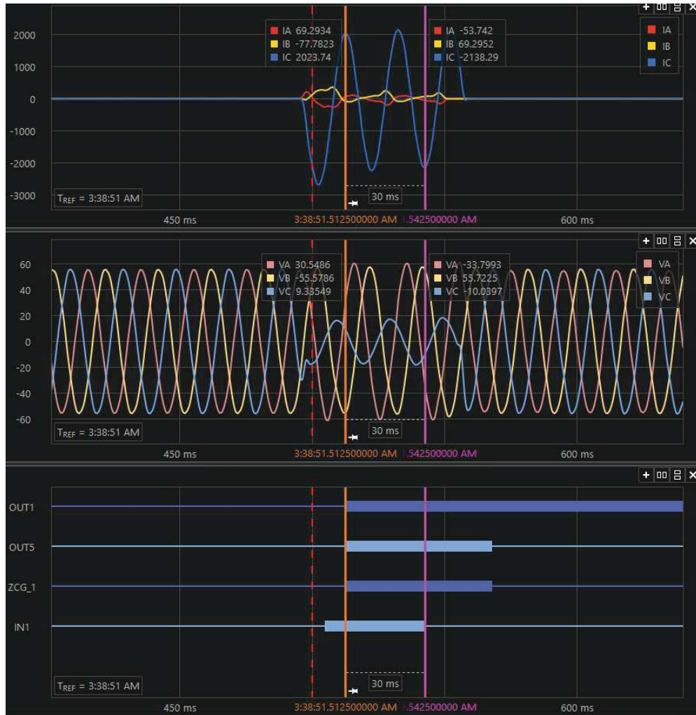
Registro oscilografico Relé SEL 321 del Paño 52B4 SE San Vicente TT.
