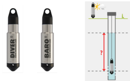
Figura 3. Características técnicas de las sondas de nivel.
