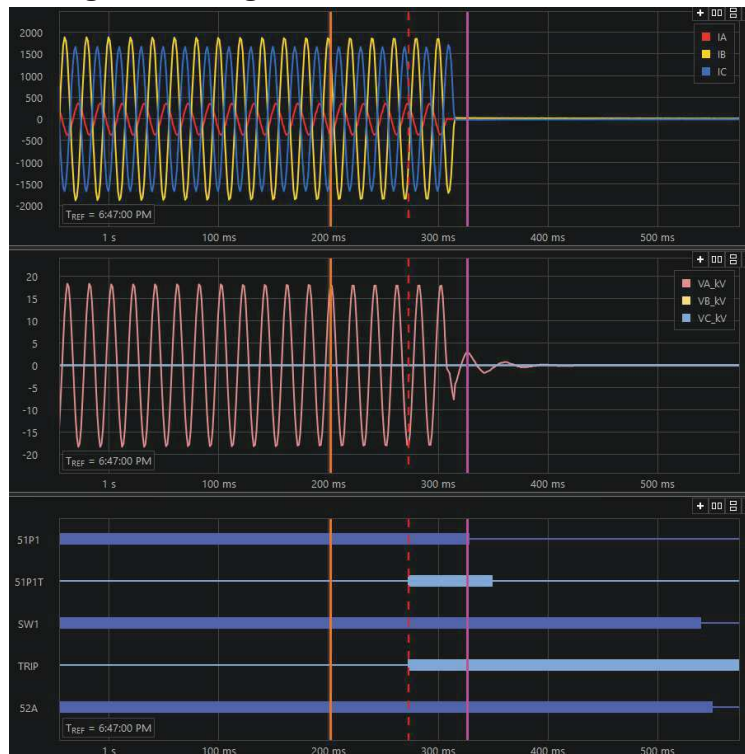
Registro oscilografico Relé SEL 387 del Paño 52CT SE Chimbarongo.
