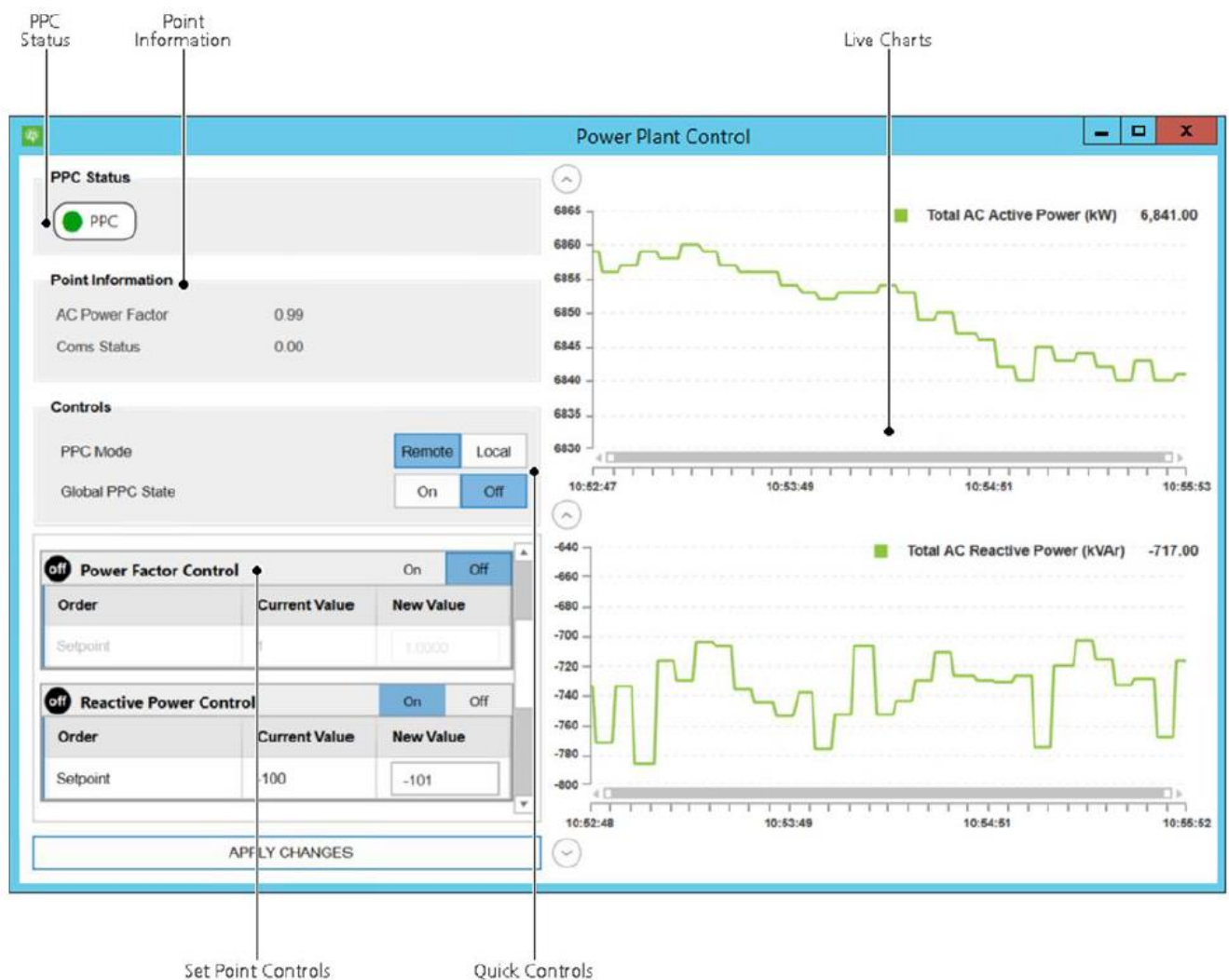
Figura 3-10: Pantalla de control y monitoreo del parque.
