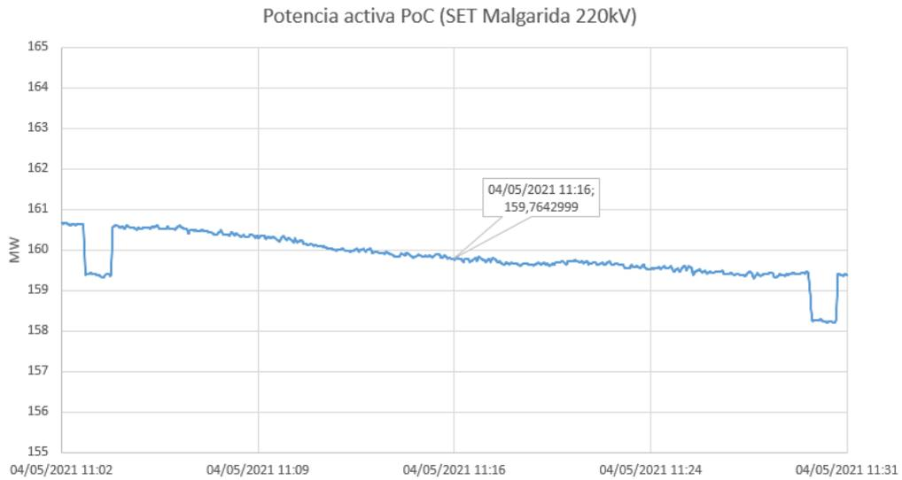
Figura 24: Potencia activa en PoC (SET Malgarida 220kV).
