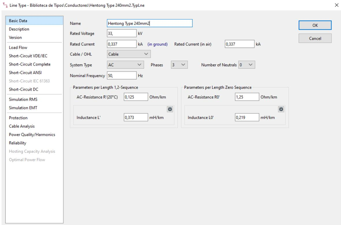
Figura 14: Modelos de cable subterráneo de 240 mm<sup>2</sup> que permiten evacuar la generación de las estaciones de potencia hasta la barra colectora de 33 kV del parque fotovoltaico Malgarida.
