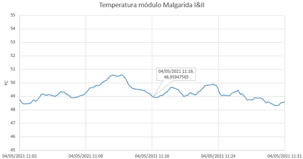
Figura 26: Temperatura de panel de Malgarida I&II.
