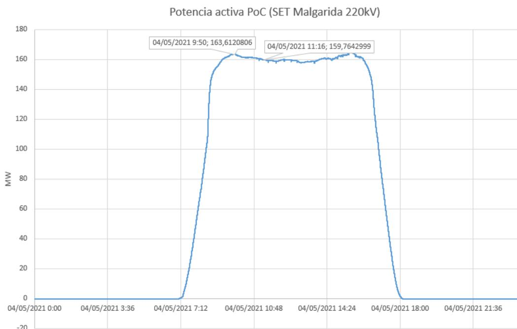
Figura 21: Potencia activa en PoC (SET Malgarida 220kV)
