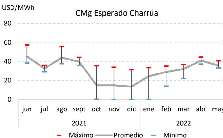
Figura 18: Costo marginal esperado en S/E 220 kV Charrúa.
