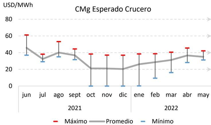
Figura 14: Costo marginal esperado en S/E 220 kV Cruceiro.
