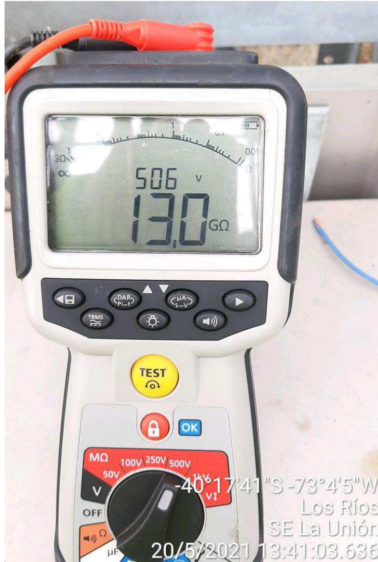
Imagen 3: Medida de aislación a punto C de cable umbilical nuevo conectado en extremo reconector.
