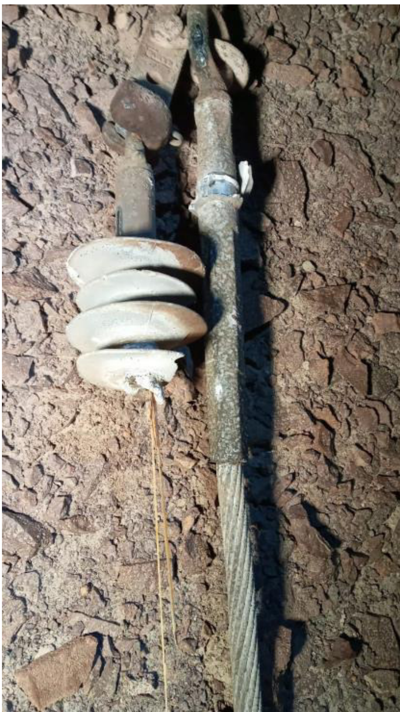
DETALLE AISLADOR POLIMERICO CORTADO EST N°16 LT ESMERALDA SUR 110 KV
