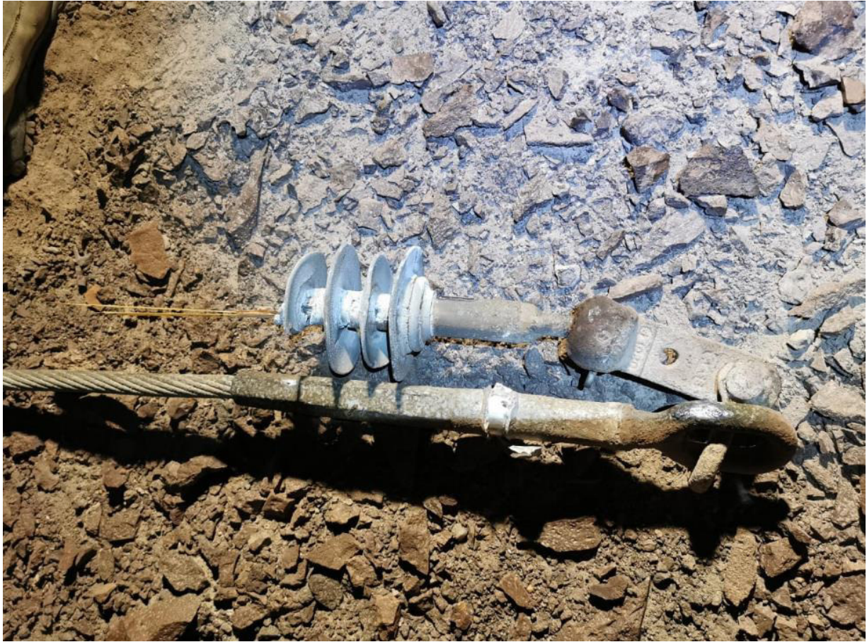
DETALLE AISLADOR POLIMERICO CORTADO EST N°16 LT ESMERALDA SUR 110 KV
