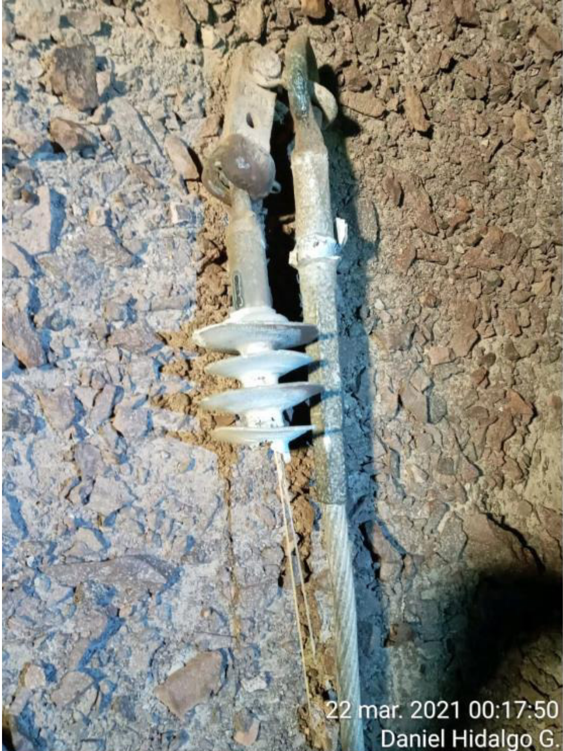
DETALLE AISLADOR POLIMERICO CORTADO EST N°16 LT ESMERALDA SUR 110 KV
