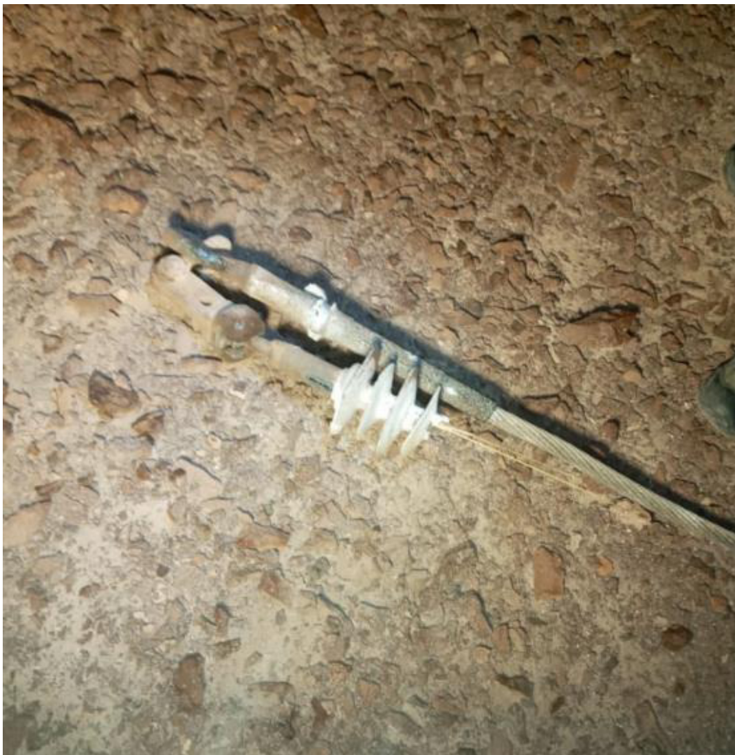
DETALLE AISLADOR POLIMERICO CORTADO EST N°16 LT ESMERALDA SUR 110 KV
