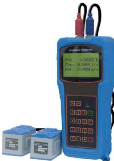
Figura 4. Características técnicas del Medidor de Caudal
