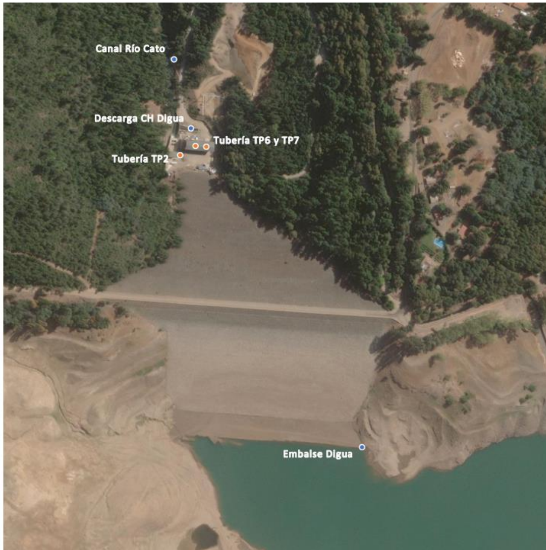
Figura 2. Imagen Satelital con indicación de los puntos donde se instalaron los instrumentos de Nivel y de Caudal.
