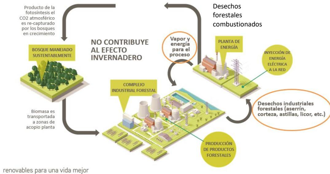
La planta de celulosa cuenta con una caldera de poder (CP) y una caldera recuperadora (CR), una turbina para producir vapor para el proceso a distintas presiones y un generador. La unidad generadora tiene una capacidad nominal de 70 MW y su producción de energía eléctrica abastece el proceso productivo y sus excedentes se inyectan al sistema eléctrico. En la tabla N°1, se encuentran las principales características de los grupos turbinas generador (TG).
