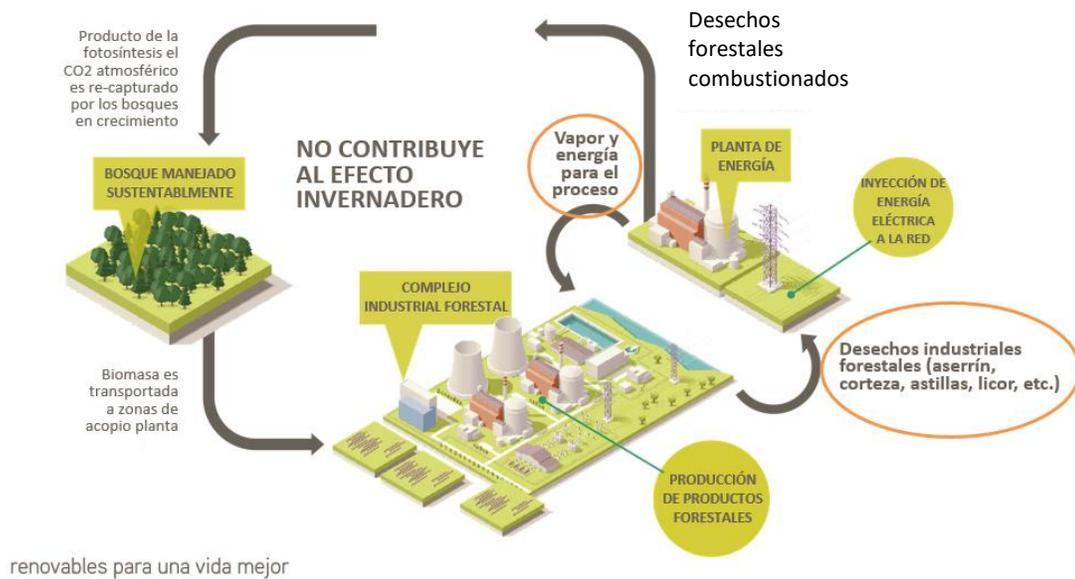
La planta de celulosa cuenta con una caldera recuperadora (CR), una turbina para producir vapor para el proceso a distintas presiones y una unidad generadora. La unidad generadora tiene una capacidad nominal de 70 MW y su producción de energía eléctrica abastece el proceso productivo y sus excedentes se inyectan al sistema eléctrico. En la tabla N°1, se encuentran las principales características de los grupos turbinas generador (TG).
