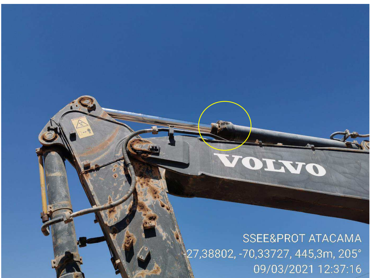
Fotografía N°2 Evidencia de la descarga eléctrica en máquina excavadora encerrado en círculo amarillo.
