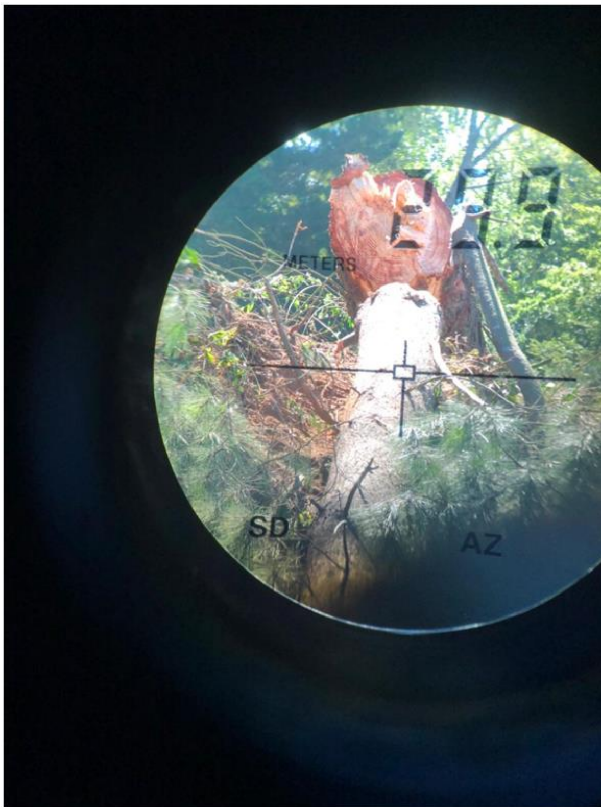
Figura 13: Distancia del eje de la línea al árbol (29,90 metros). Fuente: Transelec.
