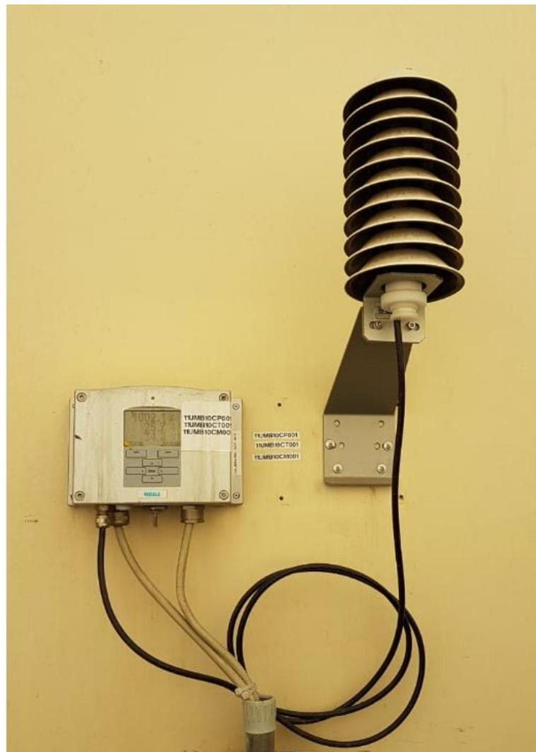
Figura 9.28 – Disposición del medidor de variables atmosféricas
