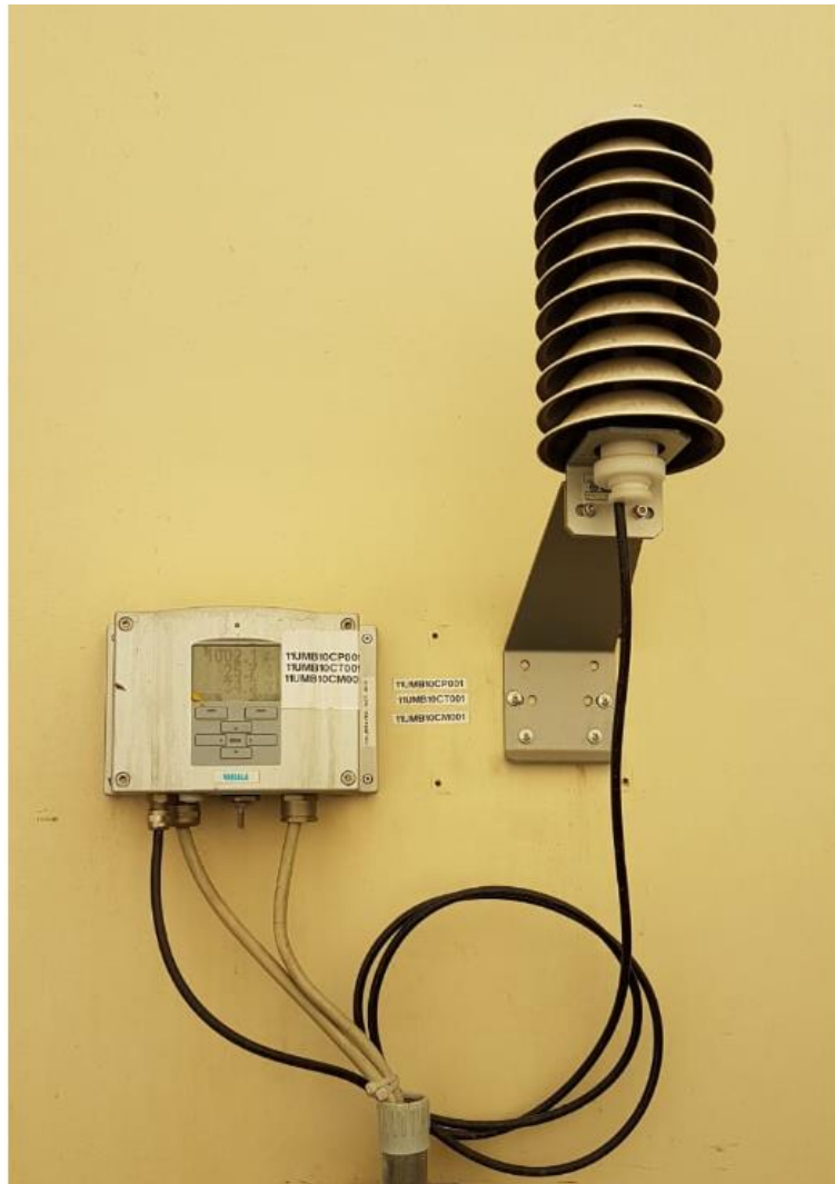
Figura 9.28 – Disposición del medidor de variables atmosféricas
