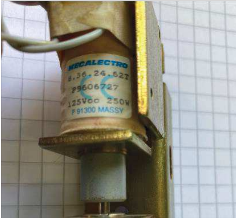
Fotografía N°3. Placa característica de Bobinas de apertura 1 y 2 - 52B3 - SE Barro Blanco.
