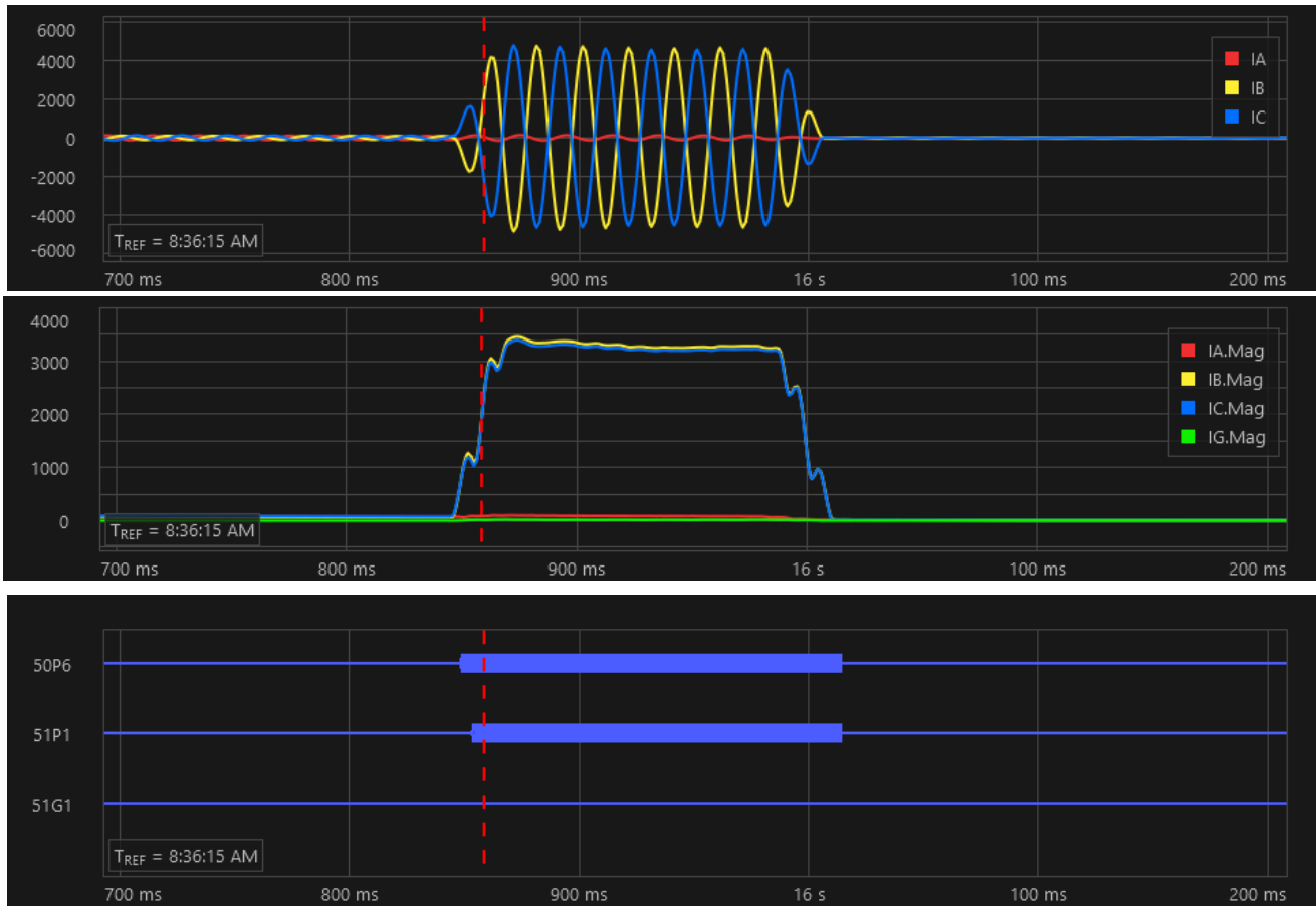
Oscilografía N°5 – relé 51/51G-E1 - SEL-651RA:
