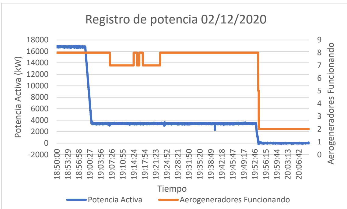
Figura 7-2 Gráfico de aerogeneradores en estado RUN al reducir la potencia.
