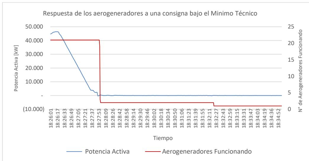
Figura 14. Gráfica aerogeneradores en servicio al reducir la potencia activa por debajo del mínimo técnico.
