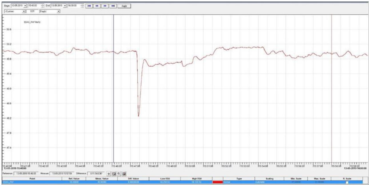
Figura 7-14: Comportamiento de la frecuencia en registro oscilográfico del esquema EDAC de S/E Temuco
