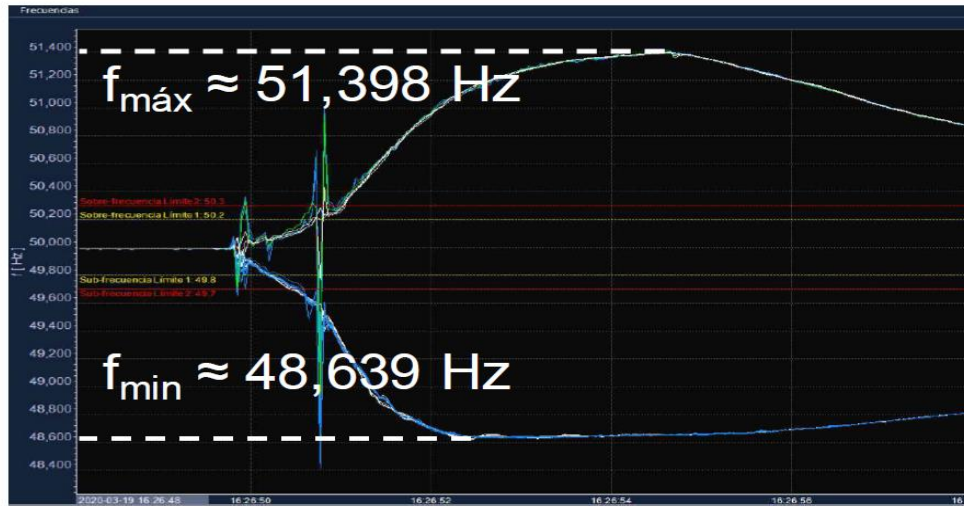
Figura 7-16 Comportamiento de la frecuencia en la isla norte y sur, luego de ocurrir la desconexión de la línea 2x500kV Nueva Maitencillo - Nueva Pan de Azúcar
