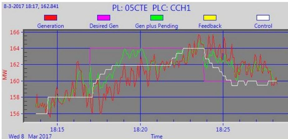
**Figura 35.** Ajuste del punto base de la unidad CCH1 de Central Cochrane, en lazo cerrado.
