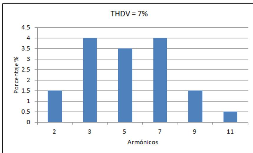
Figura 1. Armónicos para señal con THDV = 7%
