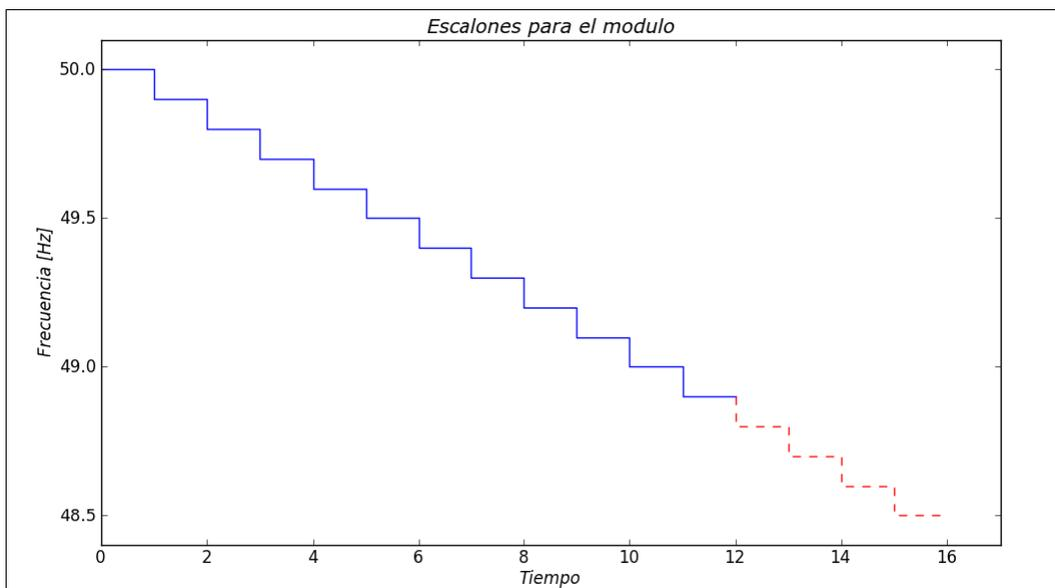
Figura 4. Rampas para evaluar el módulo de frecuencia
