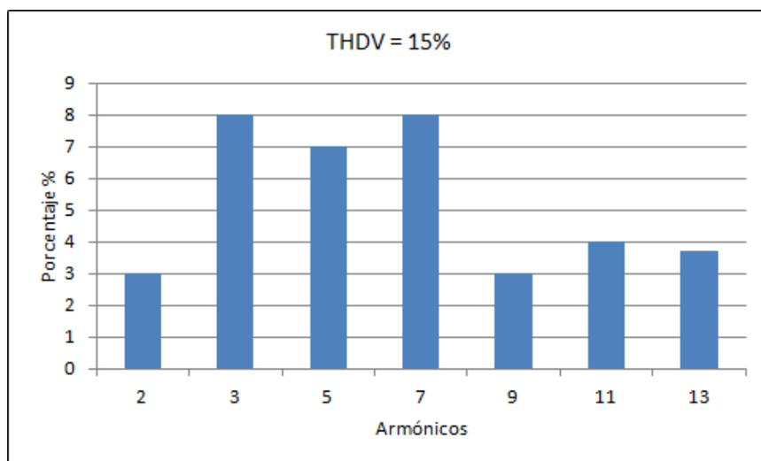
Figura 2. Armónicos para señal con THDV = 15%
