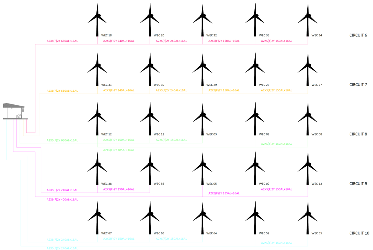
Figura 5: Diagrama Unilineal PE Sarco - Circuitos 6 al 10
