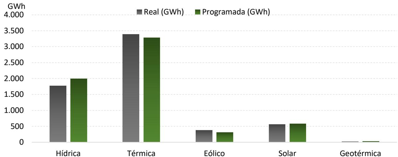
Figura 6: Comparación Generación Real y Programada por fuente.
