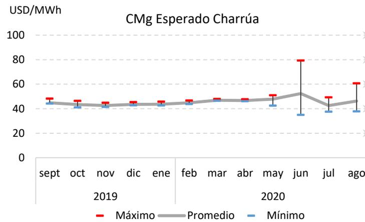
Figura 22: Costo marginal esperado en S/E 220 kV Charrúa.
