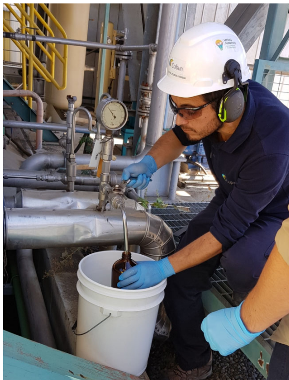
Figura 2: Personal de Colbún Los Pinos tomando la muestra de combustible en la etapa de carga E1, a 3 MW.
