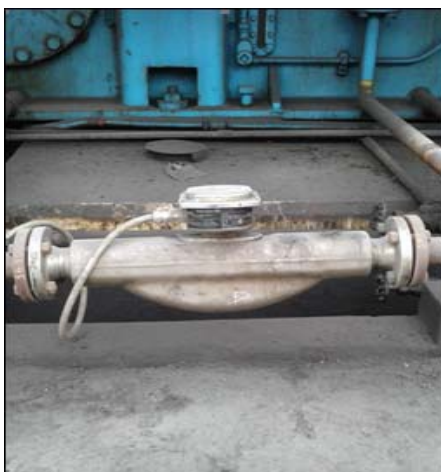
Figura 2.- Medidor Coriolis utilizado para medir consumos Diésel Oil
