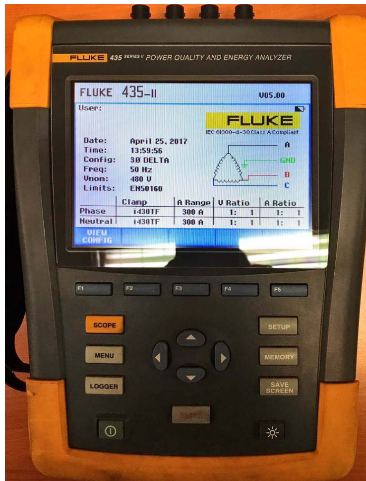
Figura 4.- Medidor Fluke utilizado para medir los SSAA
