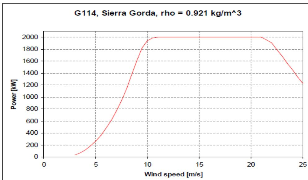
Figura 5: Curva viento-velocidad aerogenerador Gamesa G114-STD 1 CII condiciones nocturnas.
