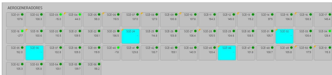
Figura 10: Registros de mínimo técnico aerogeneradores Parque Eólico Sierra Gorda.
