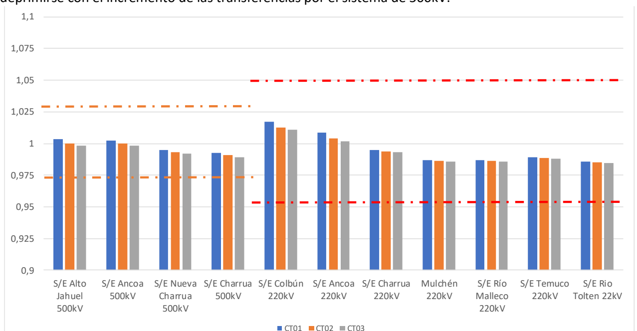
Figura 9-6 - Perfil de tensiones en barras de 500kV y 220kV del ACT Centro Sur en operación normal
