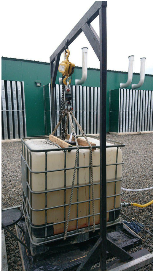
Figura 4: Instalación auxiliar para medición de consumo de combustible por masa.
