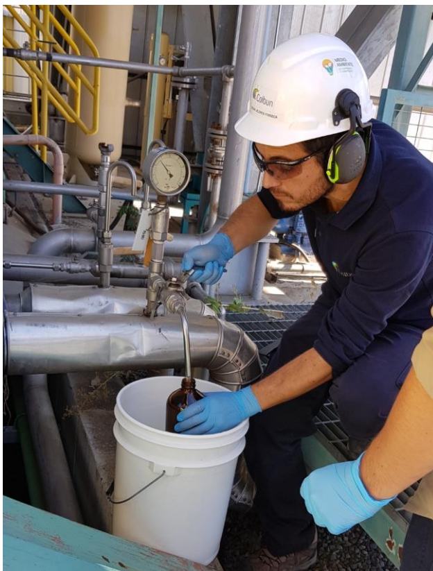
Figura 2: Personal de Colbún Los Pinos tomando la muestra de combustible en la etapa de carga E1, a 3 MW.
