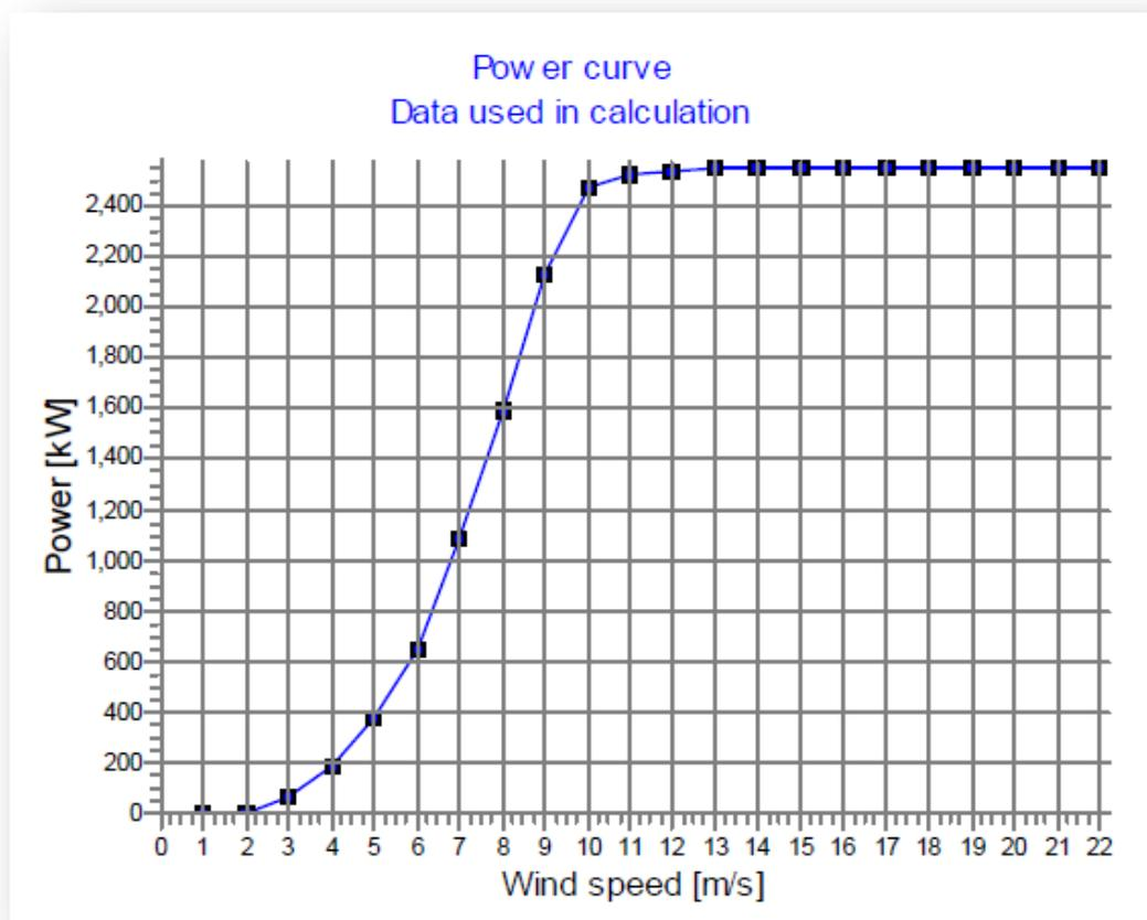
Ilustración 3 Curva de potencia teórica del aerogenerador
