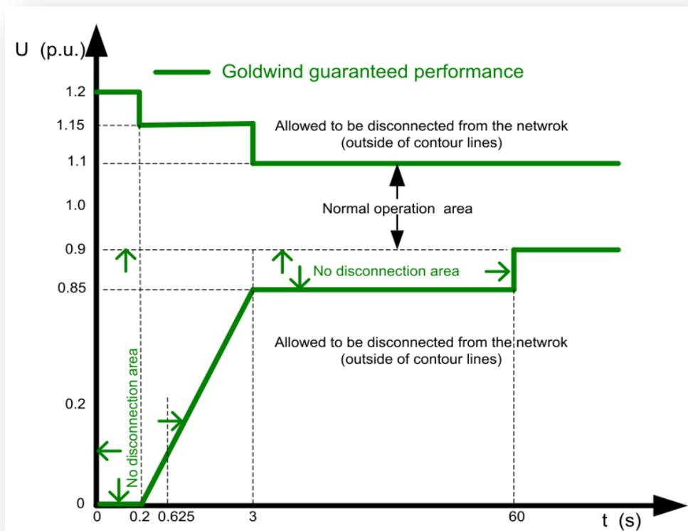
Ilustración 7: Capacidad del aerogenerador de estar conectado por cortos periodos de tiempo (LVRT/HVRT)
