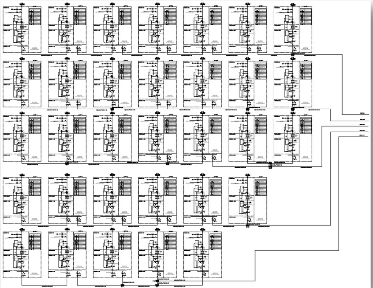
Ilustración 1: Distribución de los 32 aerogeneradores por circuito.
