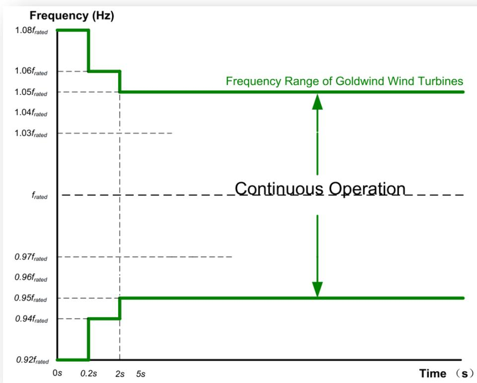
Ilustración 5: Rango de frecuencia en función del tiempo.
