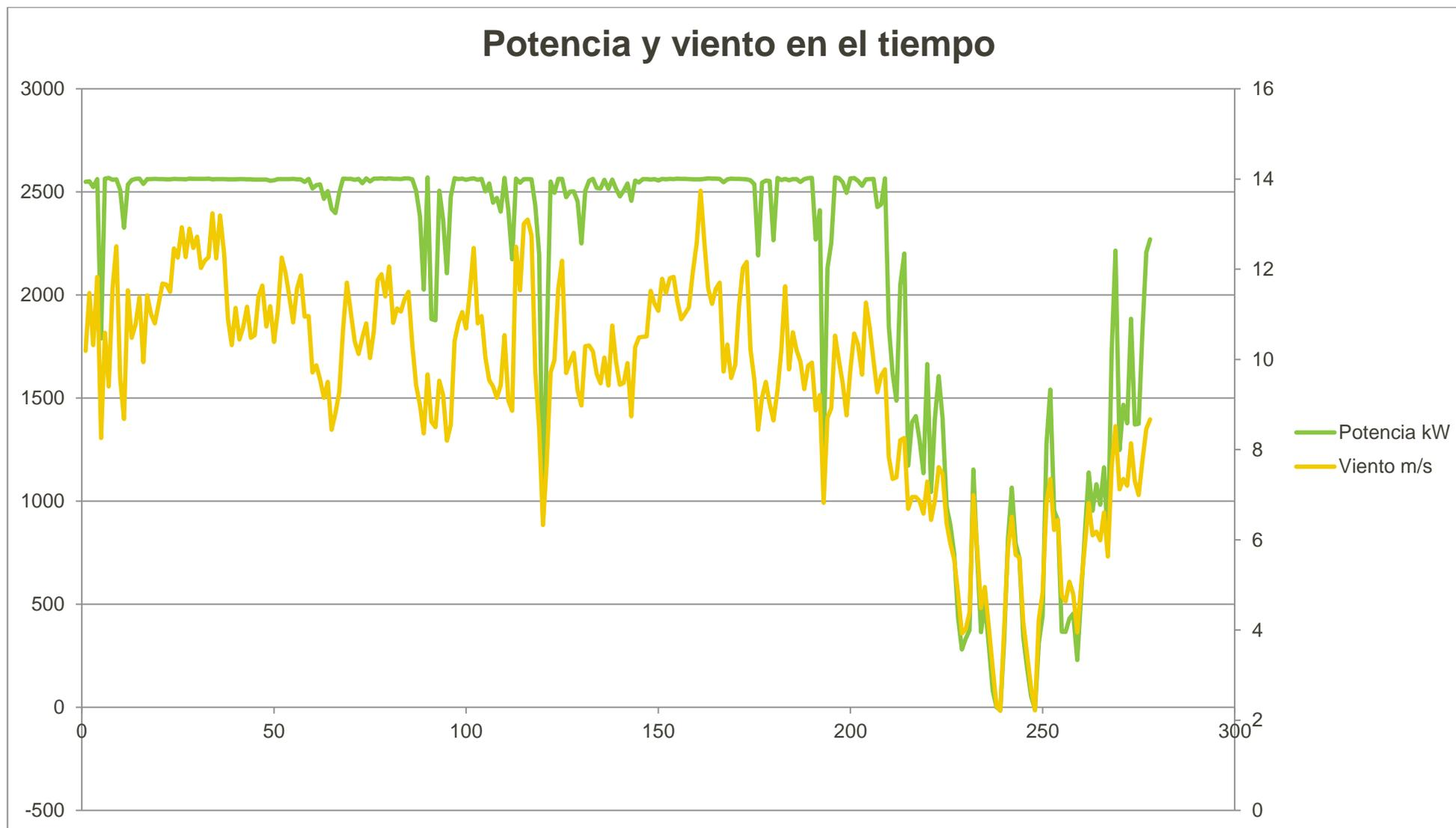
Ilustración 10: Medidas de viento y potencia en la turbina WTG01. Gráfica obtenida con una densidad del aire de 1,225 kg/m<sup>3</sup>.
