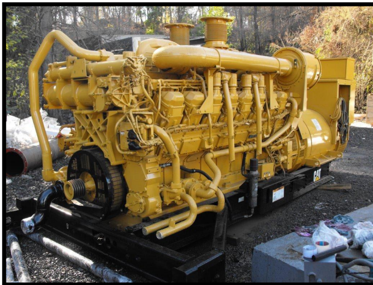
Ilustración 2-1, Unidad DS-2 MOTOR CATERPILLAR, modelo 3516B, Central Térmica Esperanza.
