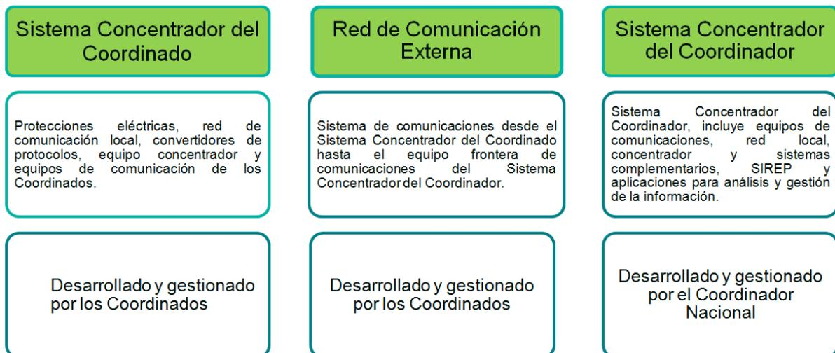
Figura 4.1 Componentes del SLRP
